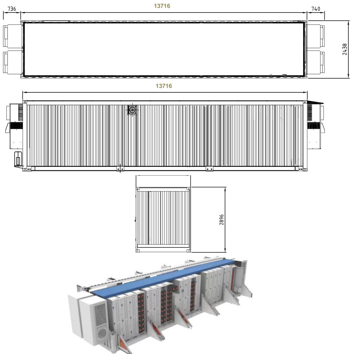
Figura 29. Modulo Container Batterie
