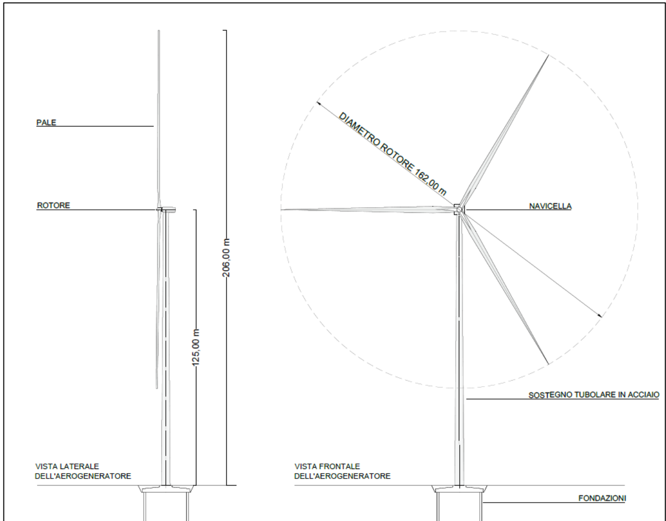
Figura 6. Tipico aerogeneratore Vestas V162-7.2 MW
