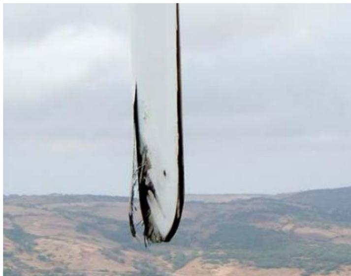
Figura 119. Particolare della pala danneggiata da un fulmine. (Fonte:VESTAS Italia srl)
