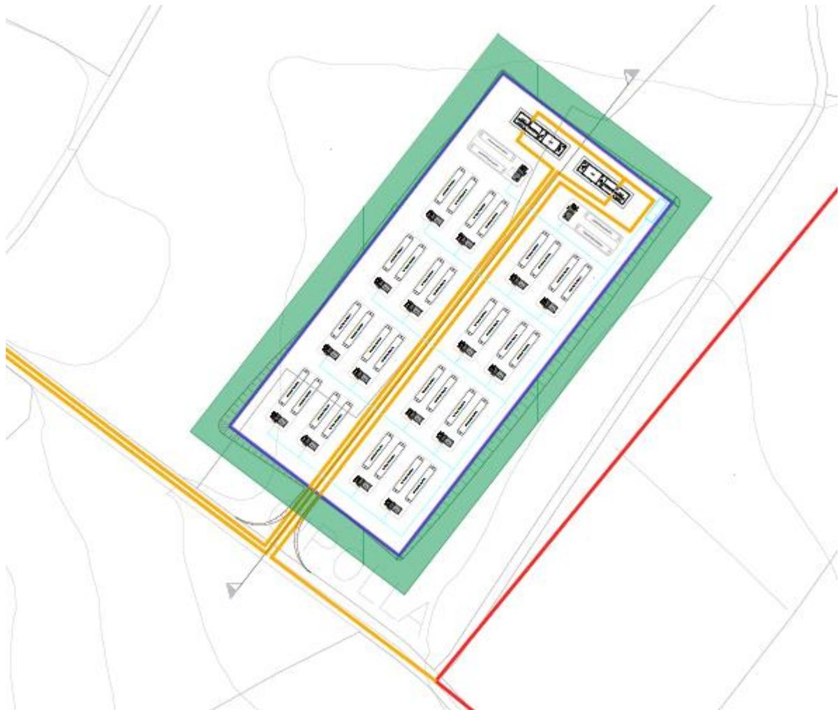
Figura 16. Planimetria SSE (cfr. elaborato cod.PD.43-Carta della Sottostazione elettrica produttore: Planimetria e Sezione).
