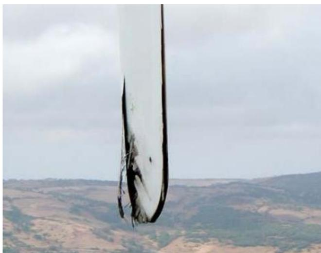
Figura 7 Particolare della pala danneggiata da un fulmine. (VESTAS Italia srl)
