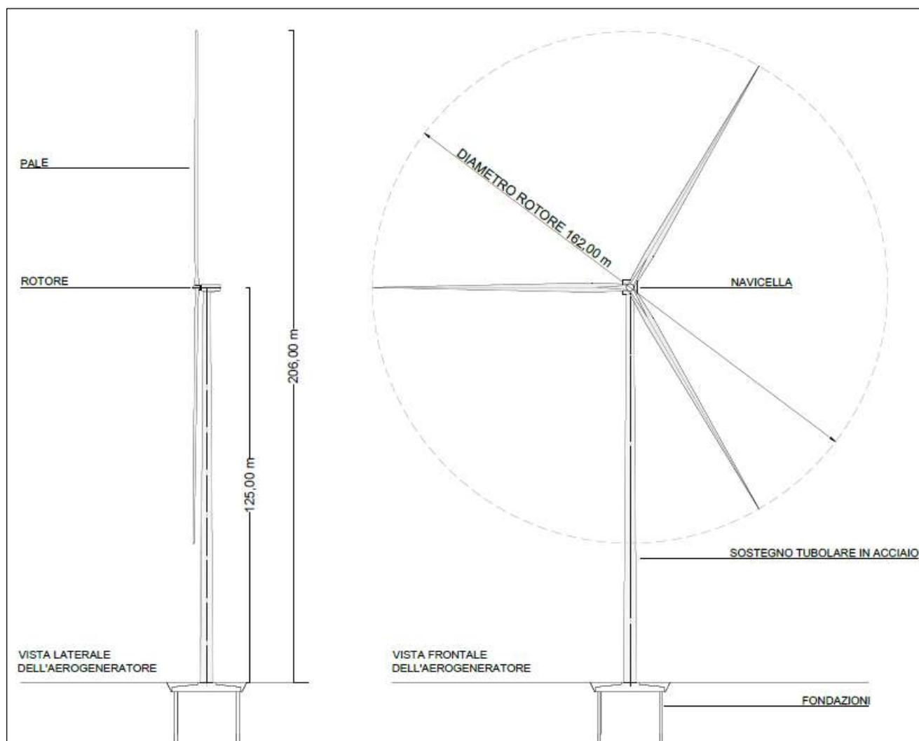
Figura 5 Schema tipo aerogeneratore avente altezza al mozzo pari a 125 m. e diametro rotore di 162 m per un'altezza complessiva di 206 m
