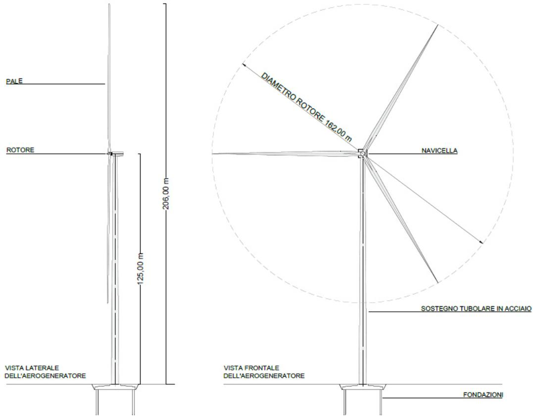
Fig.7 Schema tipo aerogeneratore avente altezza al mozzo pari a 125 m. e diametro rotore di 162 m per un'altezza complessiva di 206 m
