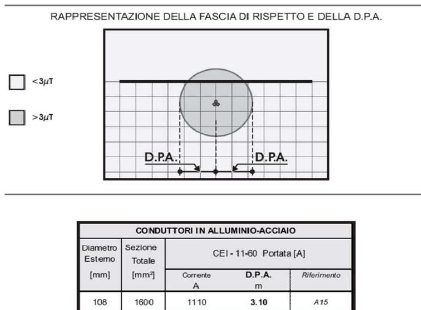
Figura 13: D.P.A per cavidotto interrato secondo norma CEI 11-60
