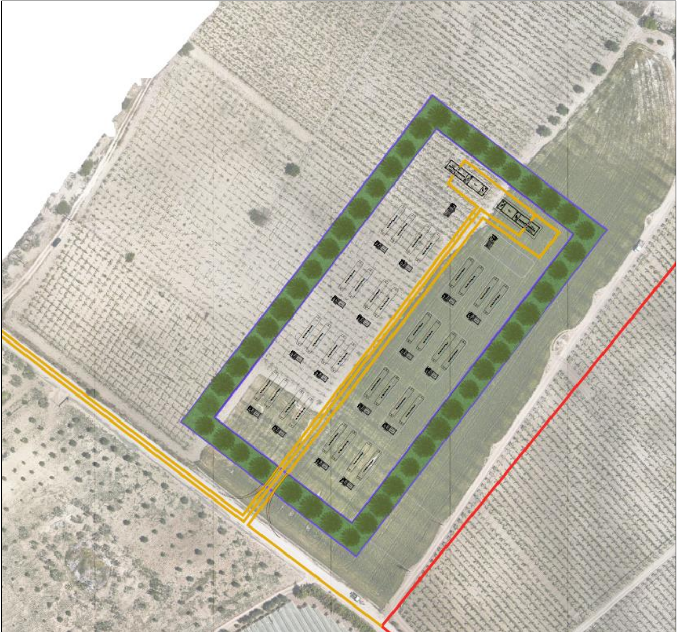
Figura 12. Fascia perimetrale arborea nell'area in cui sorgerà la sottostazione utente
