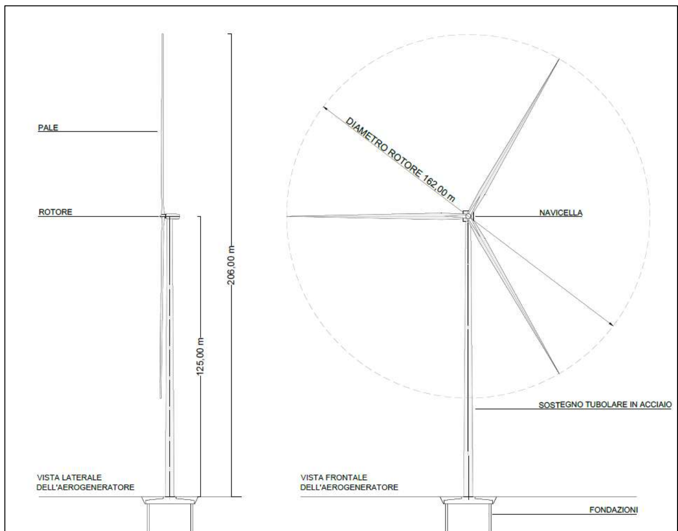
Figura 8: Tipico aerogeneratore Vestas V162-7.2 MW
