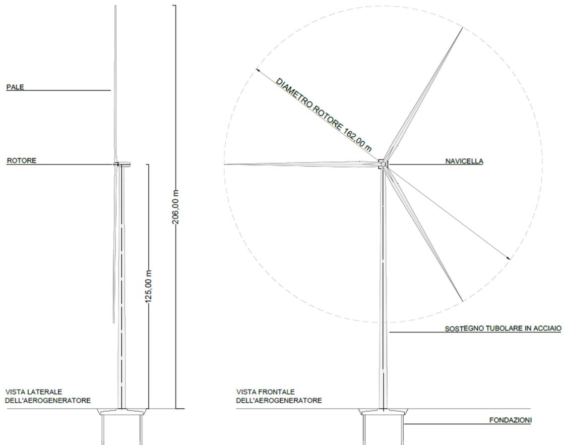
Figura 6: Tipico aerogeneratore Vestas V162-7.2 MW
