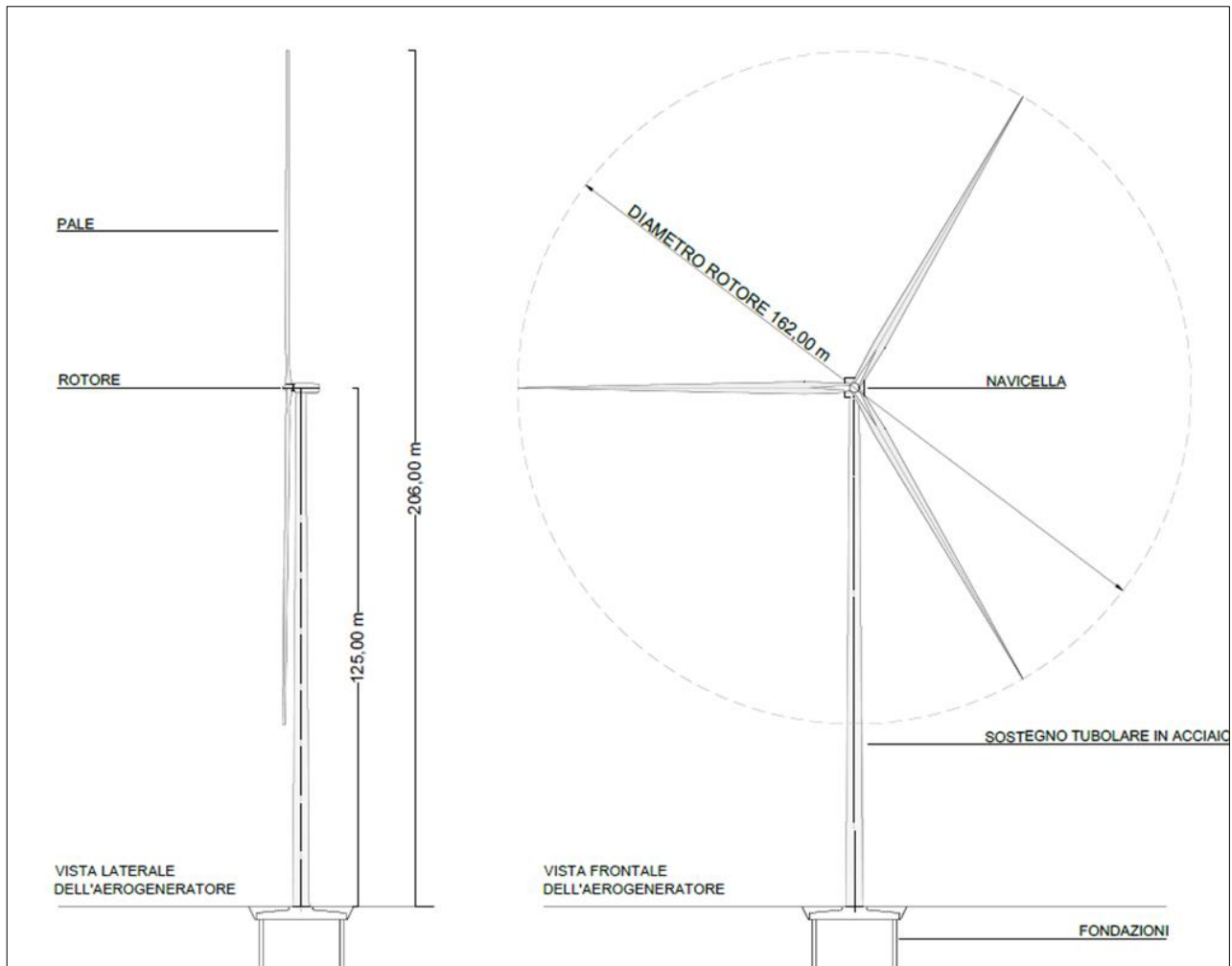
Fig. 5 Schema tipo aerogeneratore avente altezza al mozzo pari a 125 m e diametro rotore di 162 m per un'altezza complessiva di 206 m
