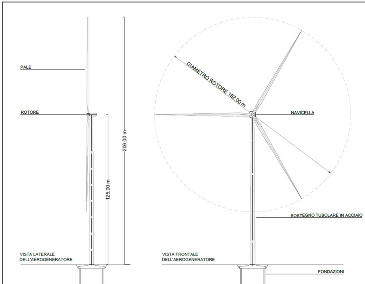
Figura 5 Schema tipo aerogeneratore avente altezza al mozzo pari a 125 m. e diametro rotore di 162 m per un'altezza complessiva di 206 m
