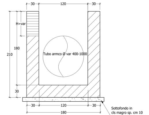
**Sezione Tipo in corrispondenza dell'attraversamento idraulico**
