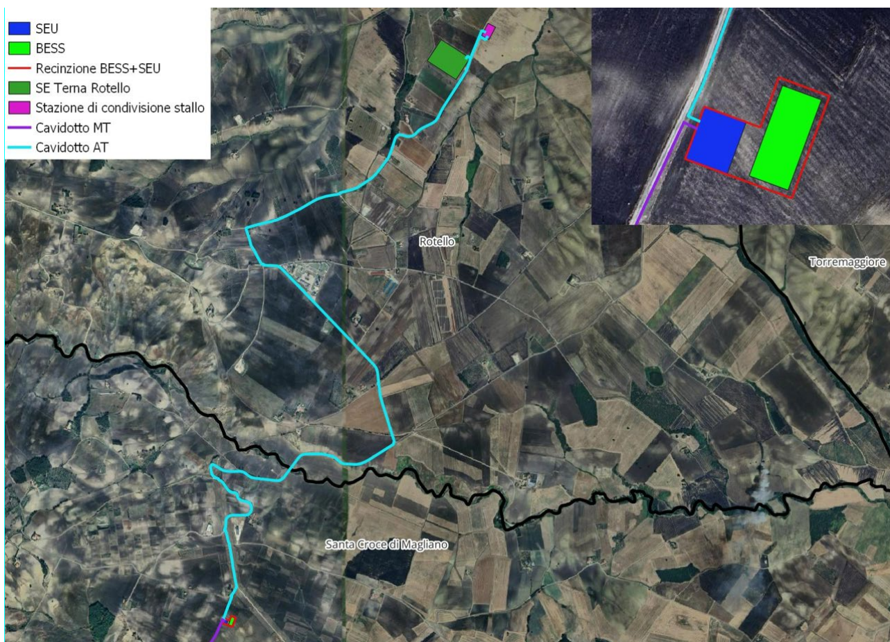
Figura 3 - Inquadramento su ortofoto delle opere elettriche connesse in progetto, con dettaglio in alto a dx della Sottostazione elettrica utente e BESS
