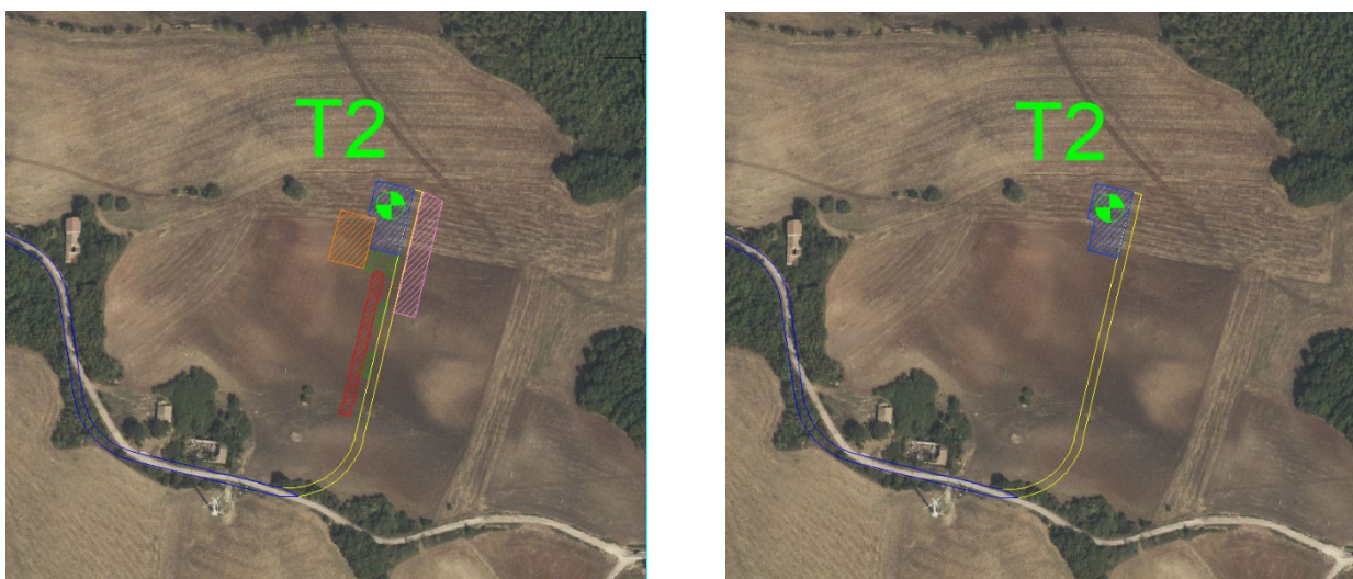
Figura 22 - Confronto aree tra fase di cantiere (sx) e fase di esercizio (dx) per la piazzola T2.
