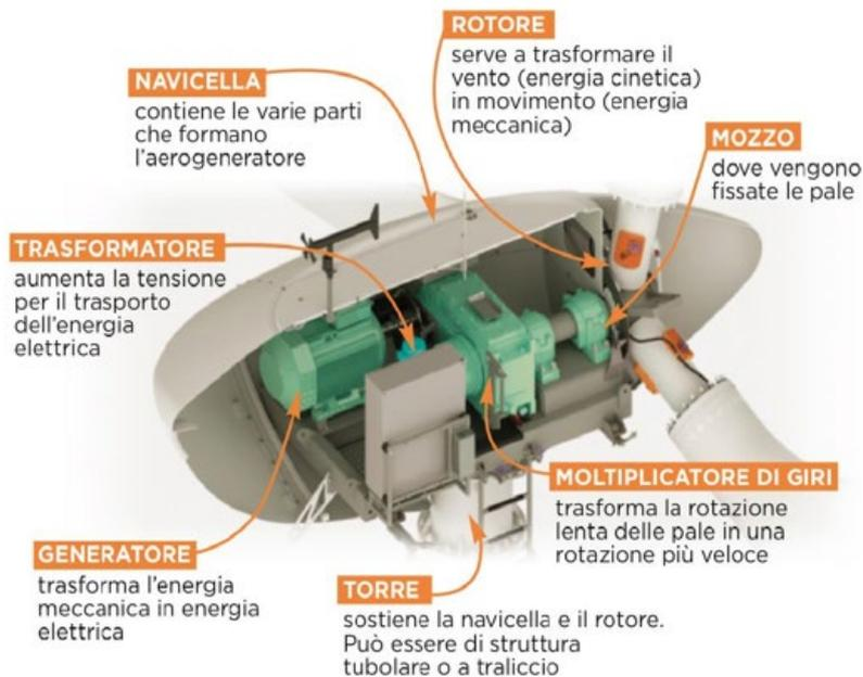
**Figure 2-2: Caratteristiche dettagliate dei componenti presenti in una turbina eolica**
