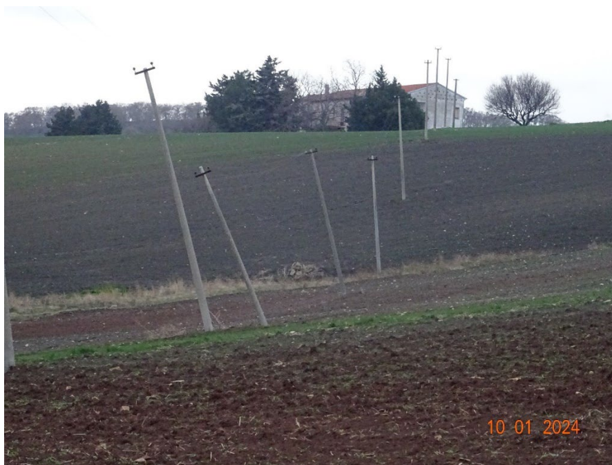
Figura 3-10: Osservazione del fenomeno di soliflusso, che influenza la stabilità delle opere con fondazioni superficiali
