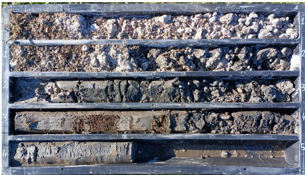
**Fig. 3.2.C**– Carote estratte dal sondaggio geognostico e riposte nella cassetta catalogatrice
