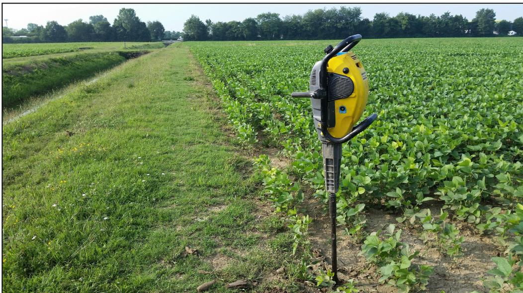
**Fig. 3.2.B - Campionatore utilizzato per l'esecuzione del sondaggio ambientale per la caratterizzazione di terre e rocce da scavo**
