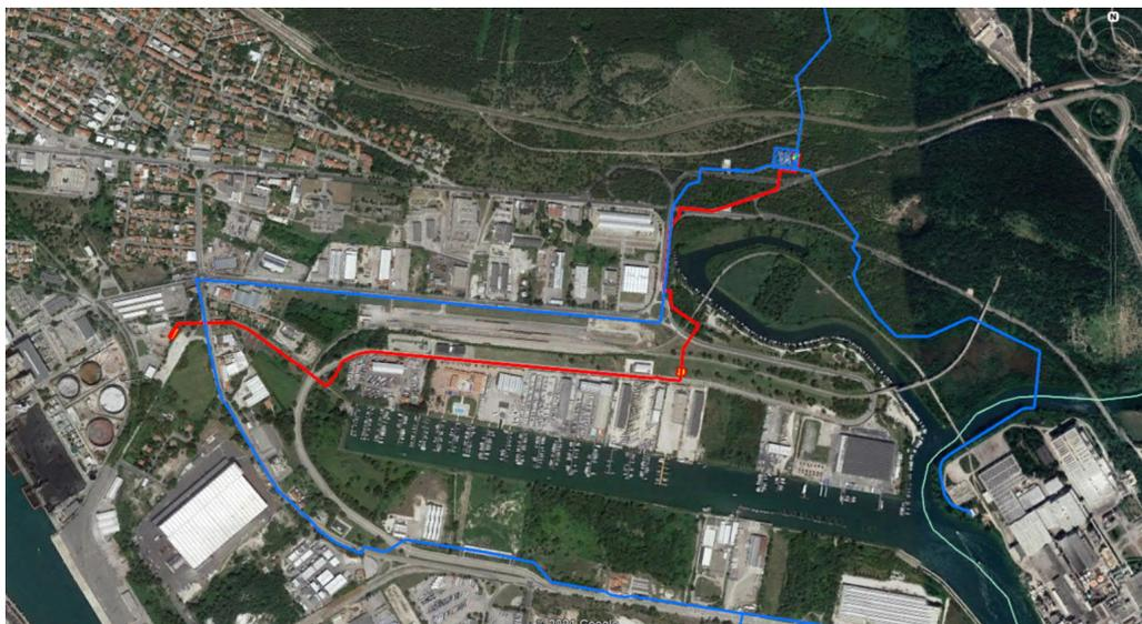
**Fig. 2.B** – Stralcio immagine aerea con localizzazione delle aree d'intervento (in rosso il tracciato di progetto ed in blu i metanodotti in esercizio)
