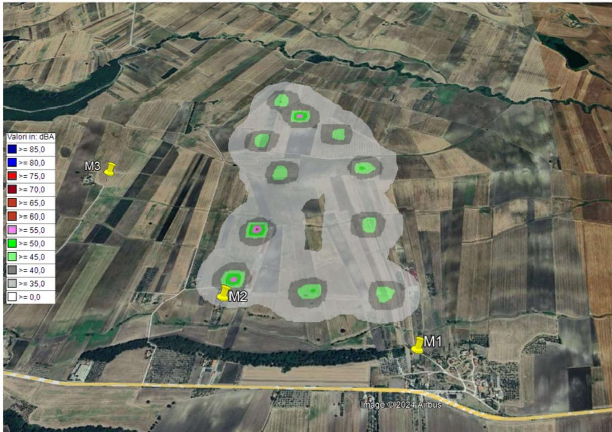
**Fig. 38 - Risultato dello studio modellistico in fase di cantiere**
