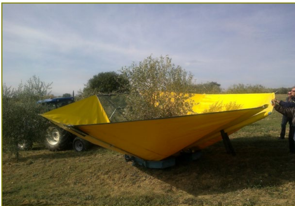
Figura 28 - Raccolta meccanizzata con braccio vibratore e telaio intercettatore ad ombrello rovesciato.
