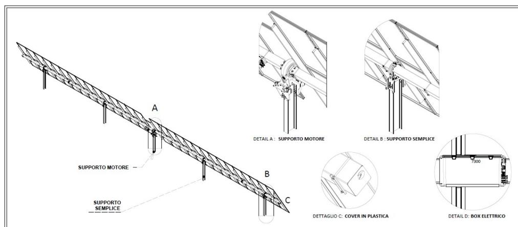
Figura 7 - Particolari costruttivi degli inseguitori installati
