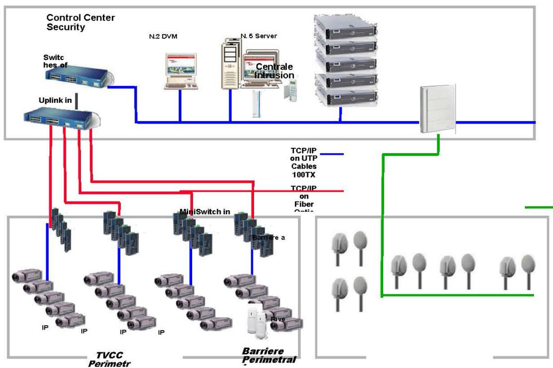
Figura 6 – Schema del Sistema di sorveglianza
