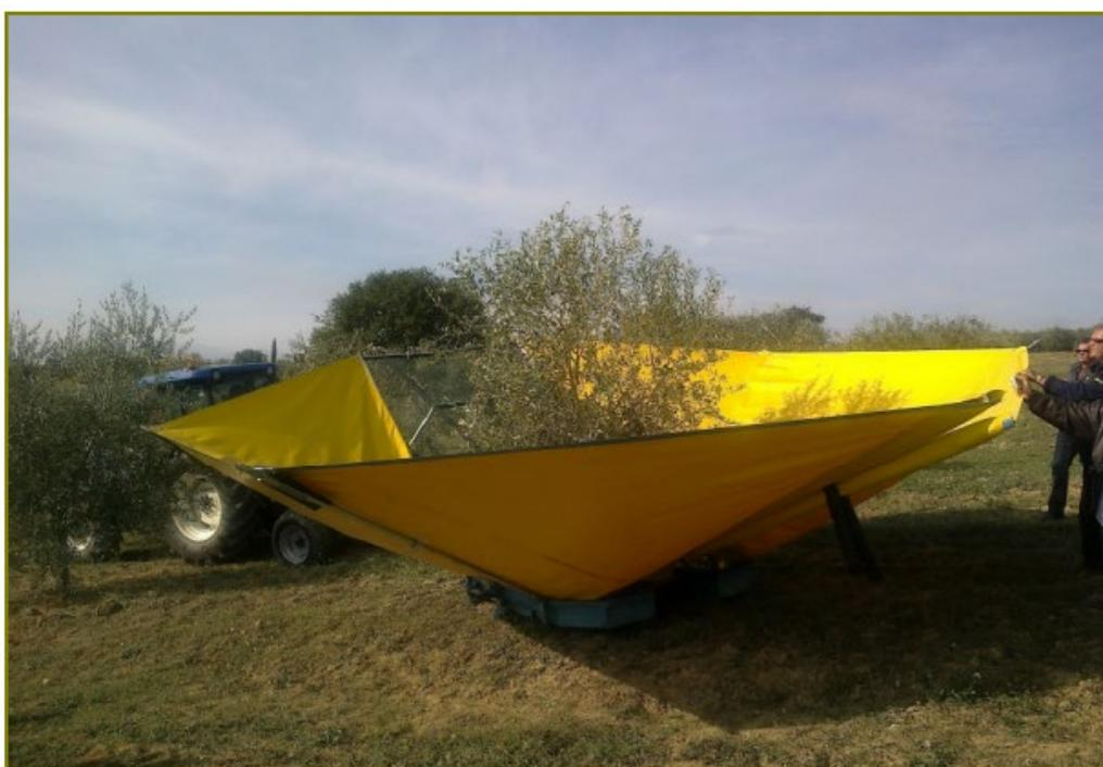
Figura 39 - Raccolta meccanizzata con braccio vibratore e telaio intercettatore ad ombrello rovesciato.
