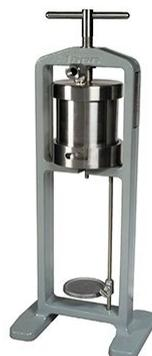
Figura 5. Filtropressa da laboratorio.
