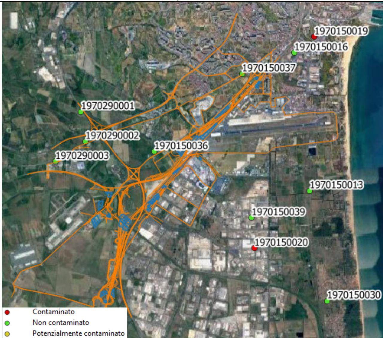
Figura 3 – Ortofoto siti contaminati/potenzialmente contaminati al 02/10/2023 rispetto alla cantierizzazione prevista (viabilità di cantiere di colore arancione, aree di cantiere di colore blu)
