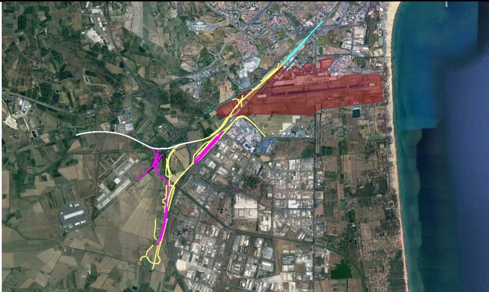
Figura 1: Corografia generale dell'intervento di interrimento della linea ferroviaria per il prolungamento della pista dell'Aeroporto di Fontanarossa di Catania e per la messa a STI del tratto di ferrovia interessato (in rosso ingombro ampliamento aeroporto).
