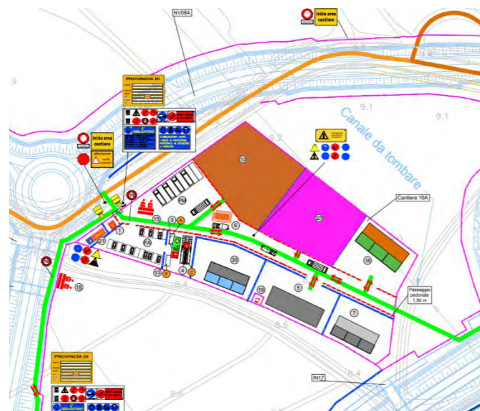
Figure 3 - Layout di cantiere
