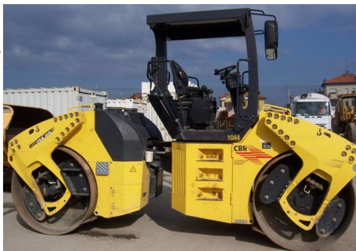
Figura 13: Rullo per conglomerato BOMAG – immagine e caratteristiche tecniche
