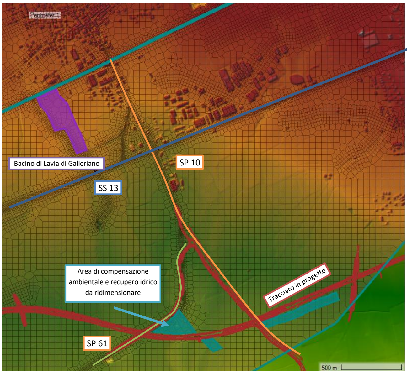
Figura 6.1; Posizione planimetrica delle opere di compensazione ambientali e recupero idraulico (verde) previste dal progetto della nuova tangenziale e bacino di laminazione proposto in questo studio (viola).
