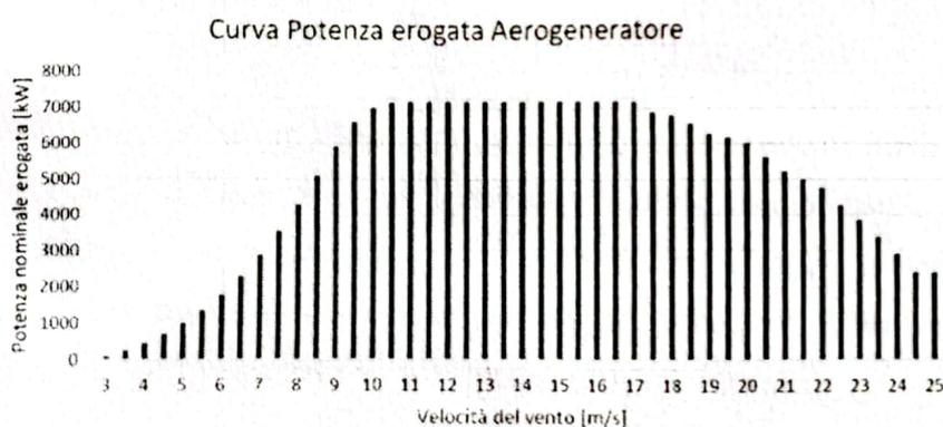
E' evidente che tale macchina sia stata progettata per essere usata con venti con velocità compresa tra 10 e 17 m/s, non presenti in zona. La località in cui dovrebbe sorgere il parco eolico (in particolare la pala WTG 05) si caratterizza per un vento medio che ad altezze di 125m s.l.s. non raggiunge i 6 m/s (Atlante Eolico Italiano <https://atlanteeolico.rse-web.it/>, vedi foto B dell'allegato 3 estratta dall'atlante eolico in riferimento al luogo di posizionamento della pala WTG 05).
