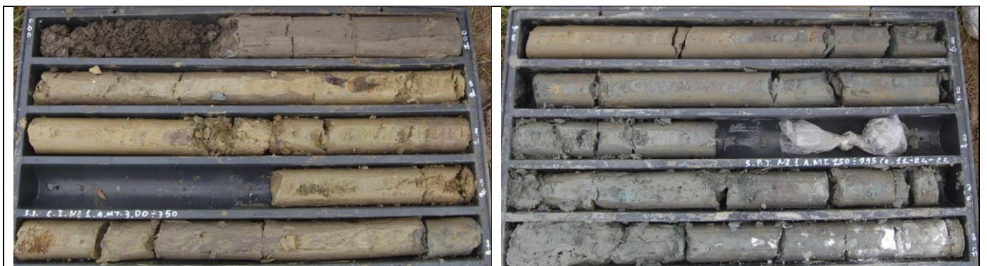
Stratigrafia "tipo" litologie caratteristiche dell'area in esame
