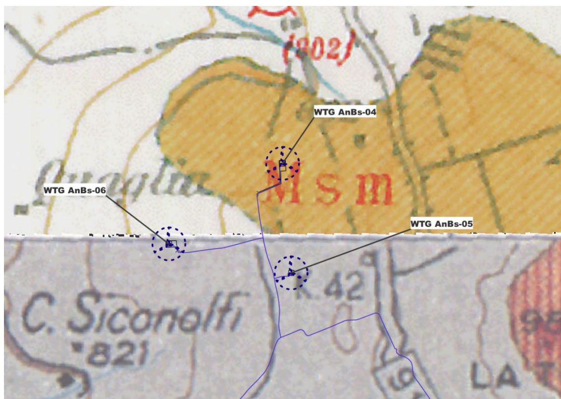
Stralcio carta geologica d'Italia Foglio 174 Ariano Irpino con indicazione degli aerogeneratori WTG AnBs-04 – Porzione di cavidotto
