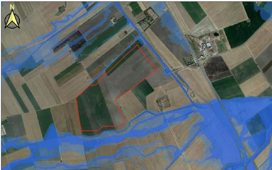
**Area impianto e stralcio dalle mappe di pericolosità idraulica del P.G.R.A.**
