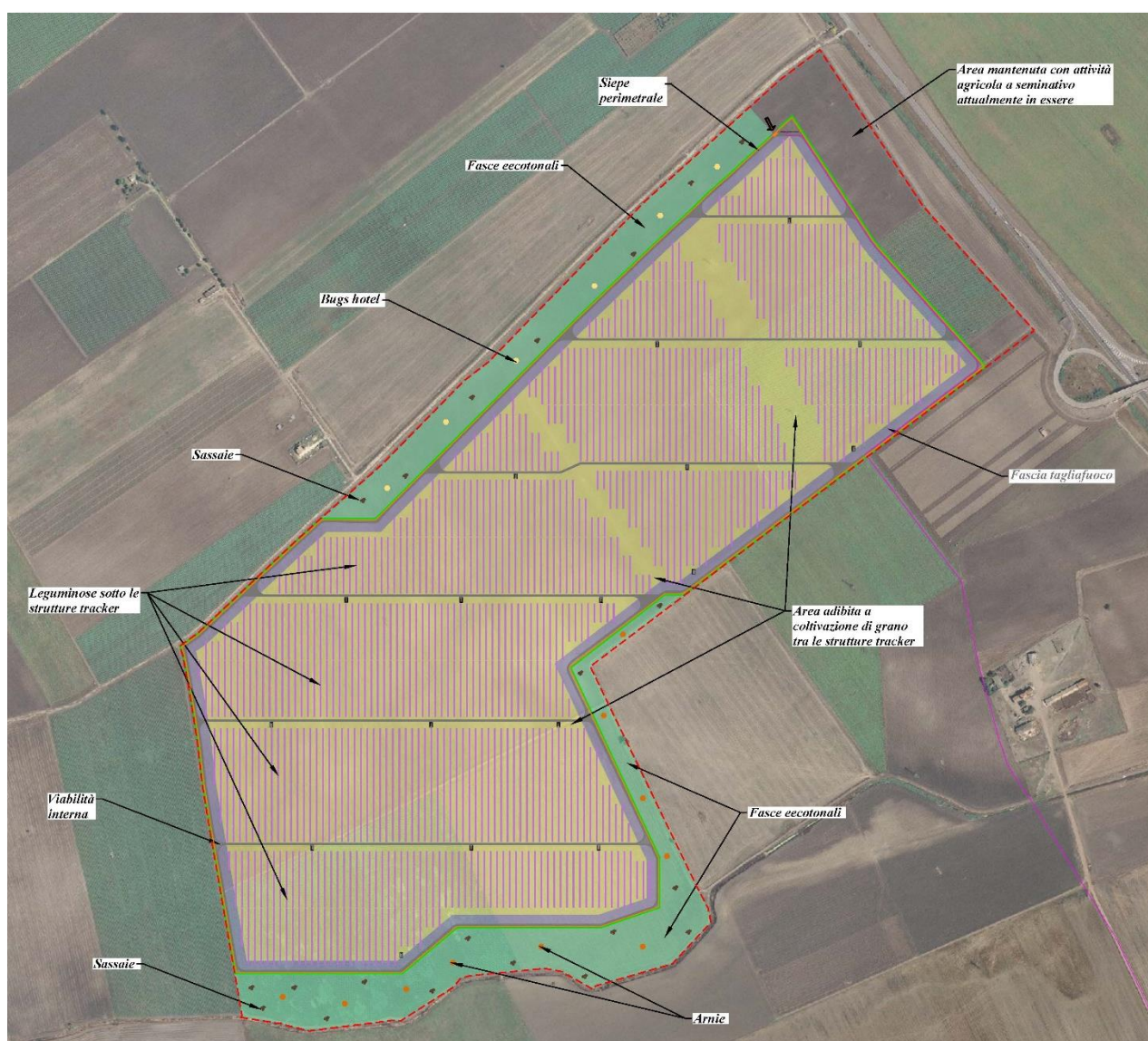
Figura 1:Layout impianto agrivoltaico "San Severo" su ortofoto
