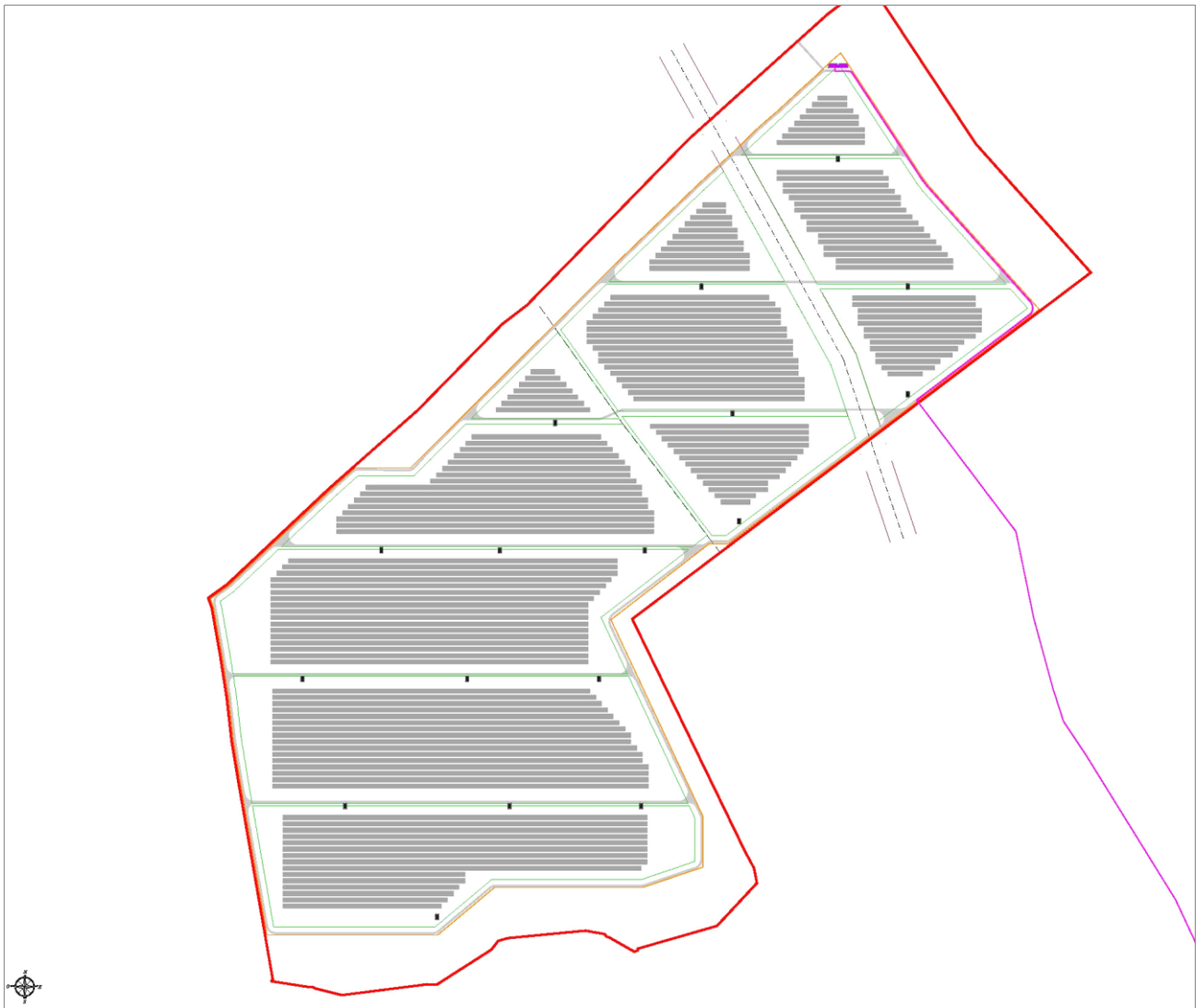
Figura 33: Impianto fotovoltaico standard "San Severo" con Fissi
