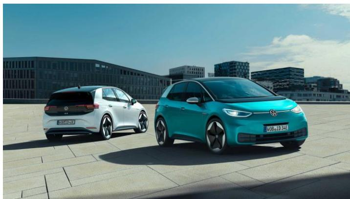
La Volkswagen ID.3 rientra a pieno titolo nel segmento C. La lunghezza di 4 metri e 26 centimetri e la larghezza di 1,81 metri sono infatti misure tipiche delle berline medie. Oltre al powetrain elettrico, contribuisce ad una buona spaziosità anche la scelta di mettere le ruote agli angoli della piattaforma MEB. Il veicolo risulta tra quelli più prestazionali in termini di consumi e lunghezza di percorrenza
