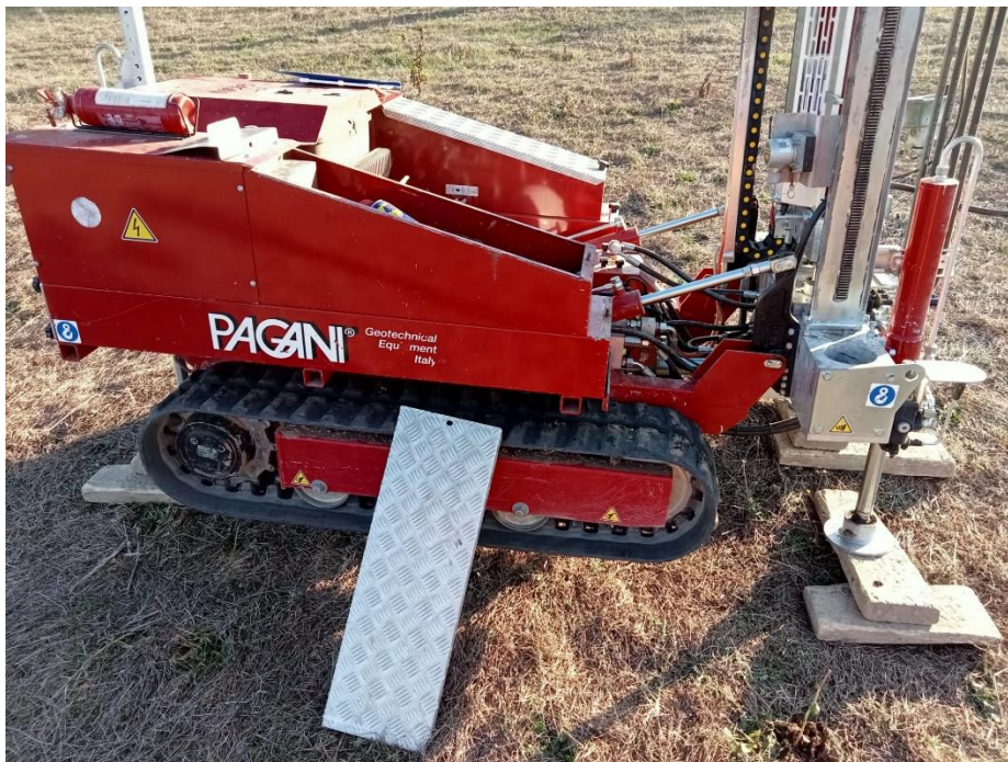
Postazione della prova Dpsh 01.
