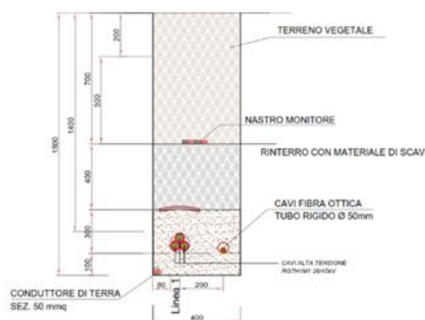
Figura 10 – Sezioni di scavo Cavo AT su terreno
