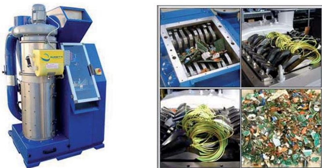
*Figura 60: Esempio di macchinari separatori*
