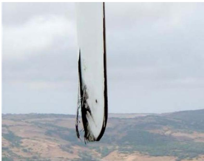
*Figura 58: Estremità di pala danneggiata da fulminazione atmosferica*
