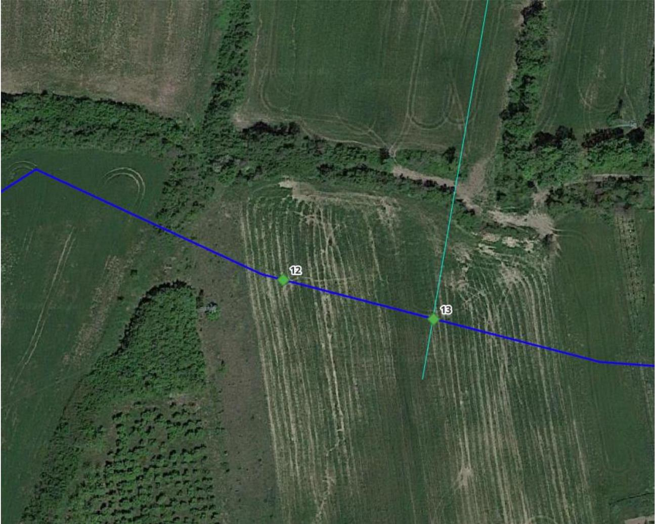
Figura 10 - interferenza aerea n.12 e interferenza superficiale con reticolo idrografico n.13 – (Google Earth)
