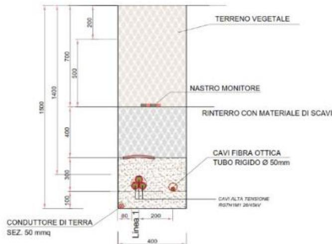
Figura 45 - sezione tipica di posa della linea in cavo
