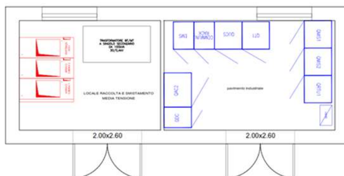
Figura 11: Tipico Cabina di Raccolta e Smistamento
