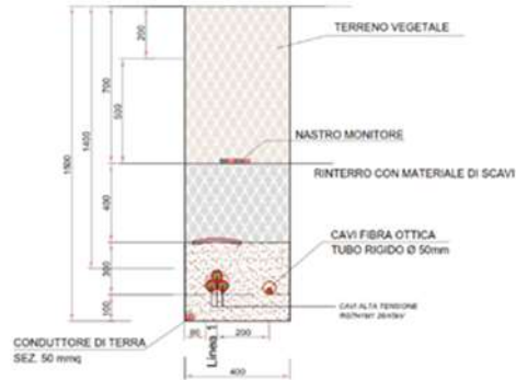
Figura 8: Sezione di scavo Cavo AT su terreno
