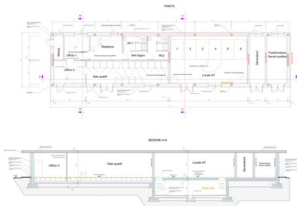
Figura 8 - Planimetria e sezioni della SSE di raccolta e controllo
