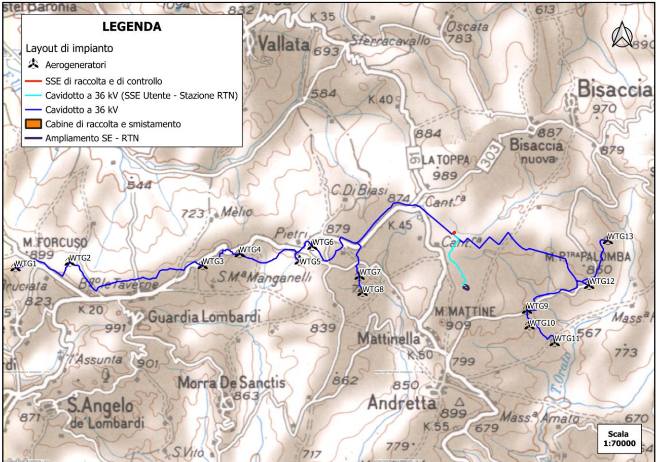
Figura 3: Inquadramento dell'impianto eolico su IGM
