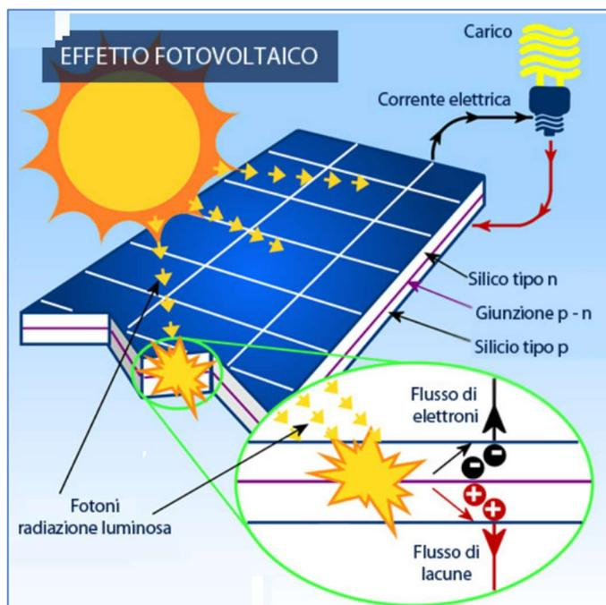
**Fig. 37**\_L'effetto fotovoltaico
