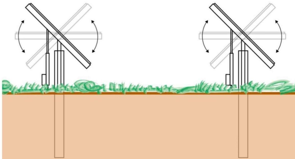
**Fig. 77\_** Schema di funzionamento della struttura ad inseguimento monoassiale
