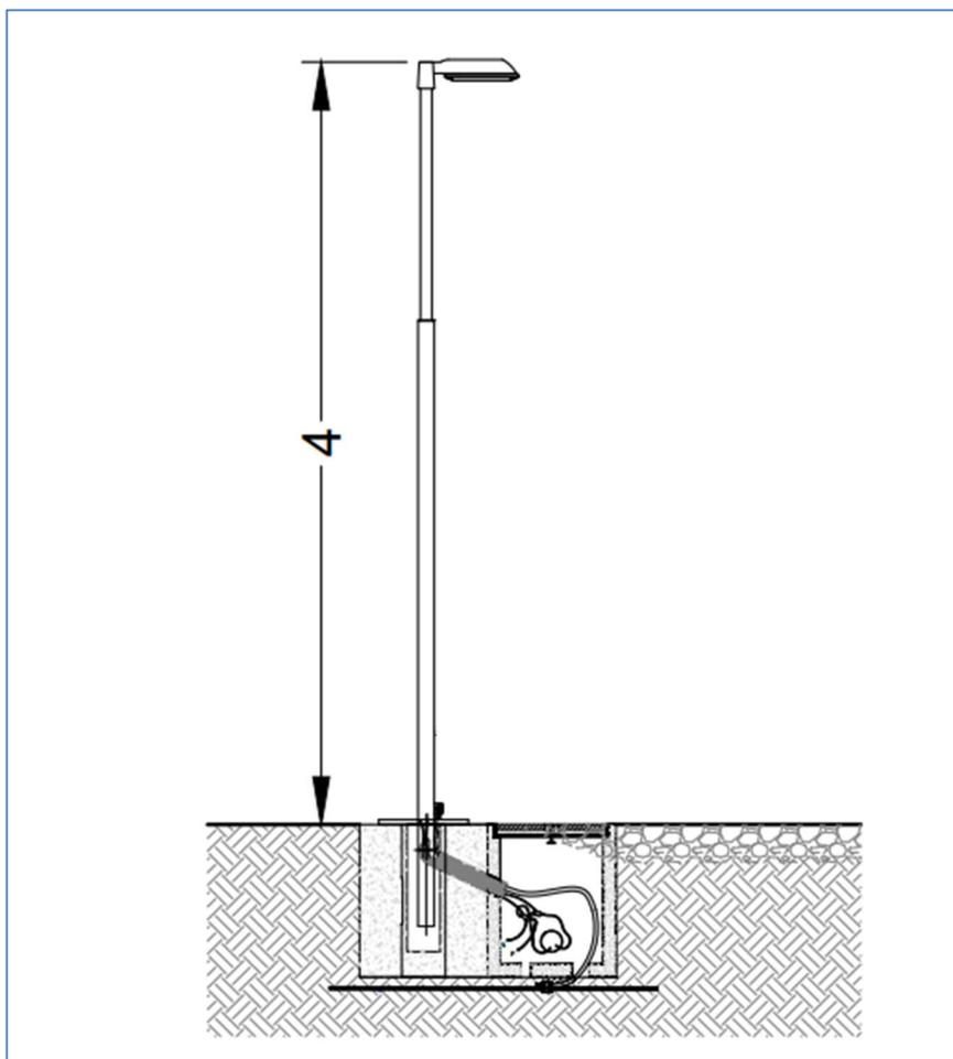
**Fig. 40** – Particolare del lampione
