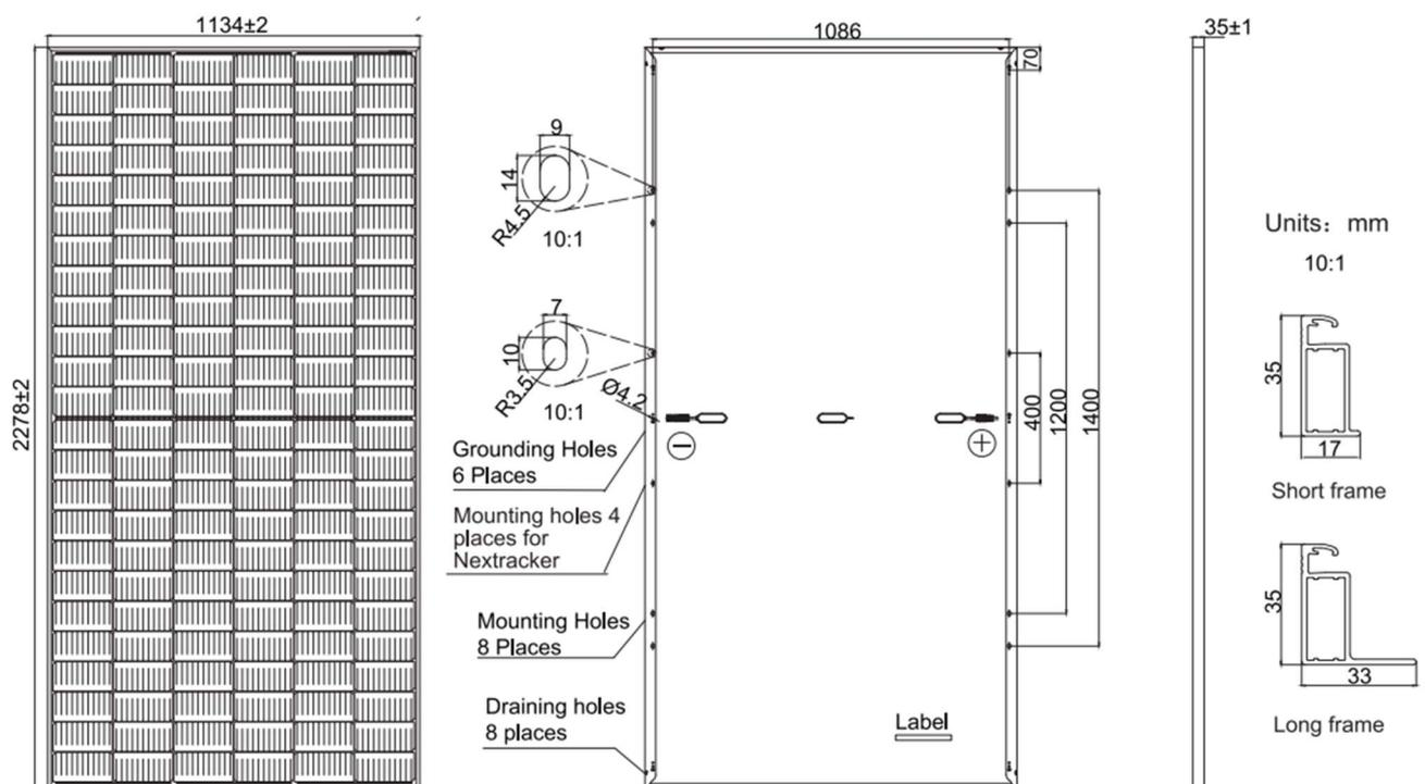
Fig. 37 – Pannello utilizzato e dimensioni
