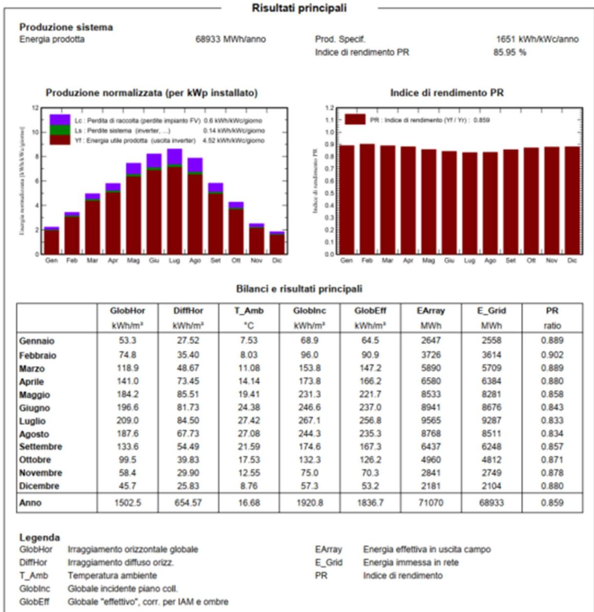
**Fig. 43** – Producibilità dell’impianto fotovoltaico
