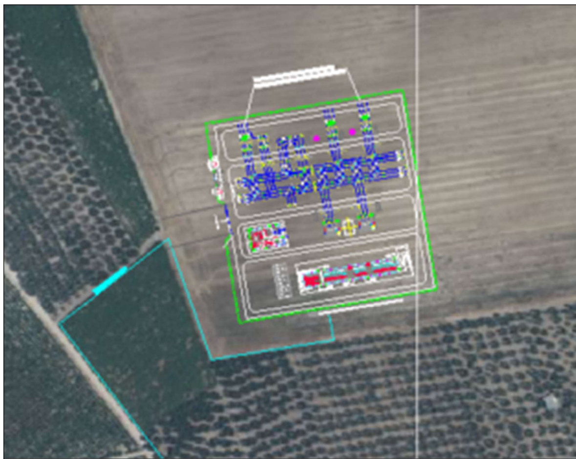
Figura 8 - Stazione elettrica a 36 kV
