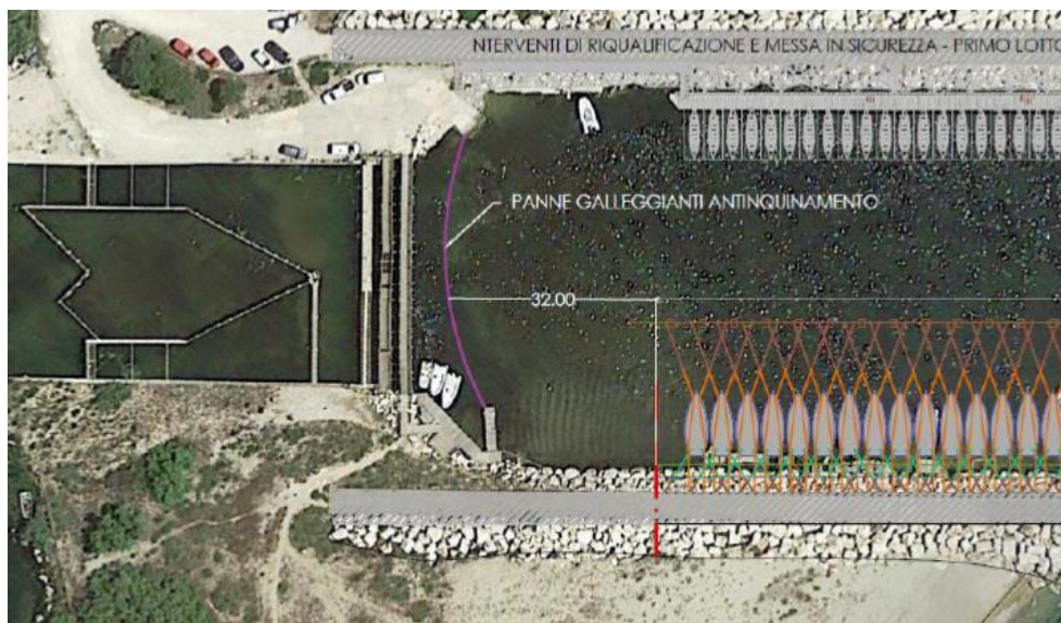
Fig. 3 – Installazione barriera marina galleggiante
