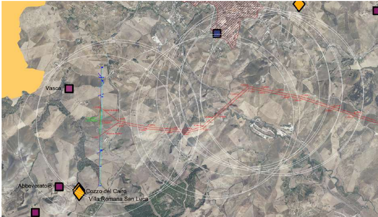
Fig. 28 - Porzione di linea con i sostegni il cui buffer (di ampiezza 1,5 km) include uno o più punti di interesse paesaggistico.
