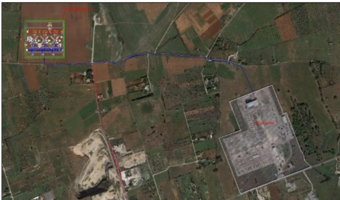
**Figura 14:** Ubicazione sottostazione elettrica onshore 220/380 kV su ortofoto
