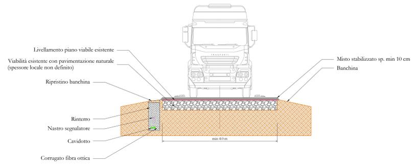
**SEZIONE TIPO 2: RISANAMENTO E ALLARGAMENTO DI PAVIMENTAZIONE STRADALE ESISTENTE**
