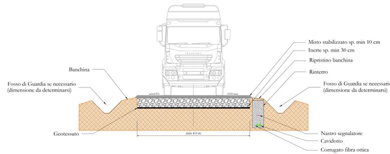
**SEZIONE TIPO 5: VIABILITA' TEMPORANEA IMPIANTO EOLICO CON ALLARGAMENTO IN CURVA**
