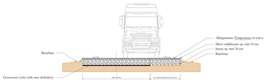
**SEZIONE TIPO 3: PAVIMENTAZIONE ESISTENTE IN PESSIMO STATO**
