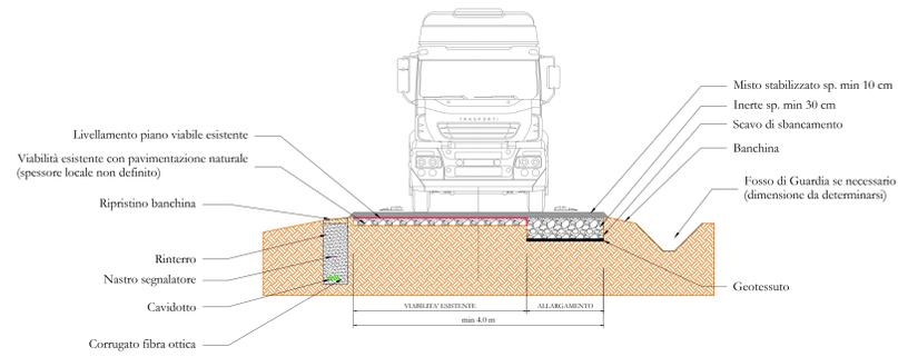
**SEZIONE TIPO 4: VIABILITA' FASE DI ESERCIZIO IMPIANTO EOLICO**
