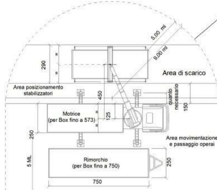
Distanza entro la quale non è possibile avvicinarsi durante le operazioni di movimentazione del box. Quando il box raggiungerà la misura di cm. 10 dal suolo sarà consentito l'avvicinamento del personale autorizzato alla guida allo scarico.
