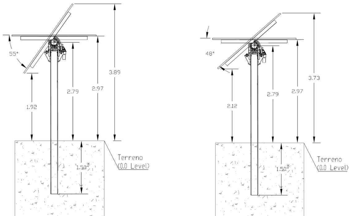
**Figura 3 – Stato di progetto vs Stato modificato.** A Sx Stato di progetto con altezza minima dei moduli pari a 1,92 m. A Dx stato modificato con altezza minima dei moduli dal suolo pari a 2,12m mediante limitazione meccanica della rotazione massima dei tracker di un angolo di  $\pm 48^\circ$
