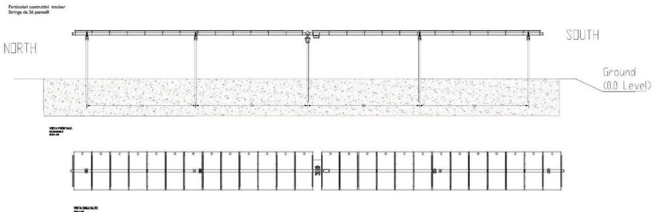
*Figura 2 – Stato di progetto. Vista laterale e vista dall'alto della singola stringa da 26 moduli*
