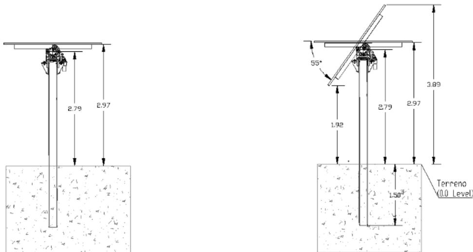
*Figura 1 – Stato di progetto. Particolari costruttivi dei tracker in rev. 01 del 07/02/2022 con rotazione dei tracker di un angolo massimo di  $\pm 55^\circ$ .*
