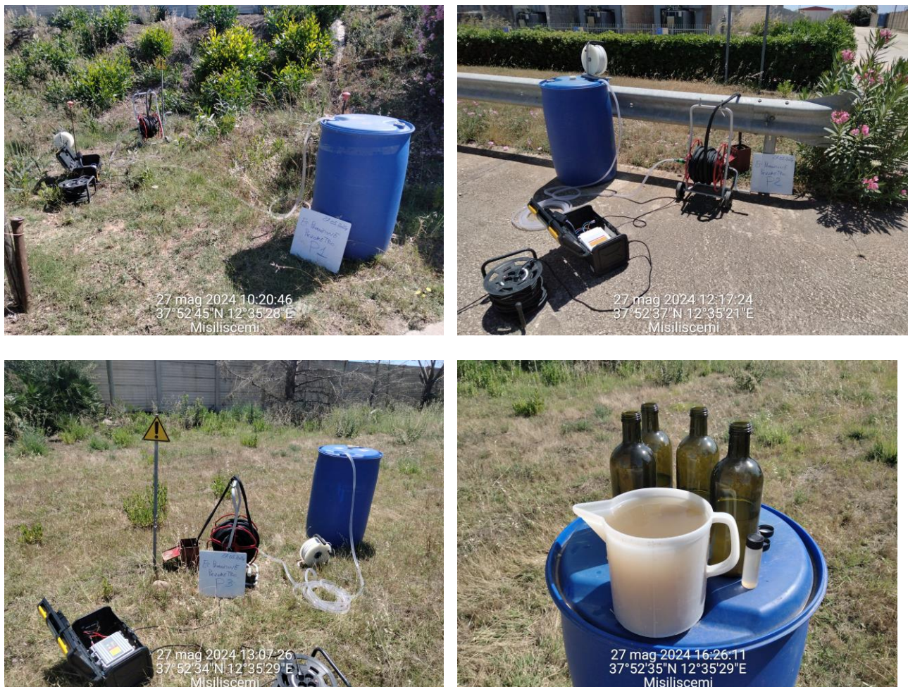
Figura 2: Documentazione fotografica fasi di spurgo e campionamento
