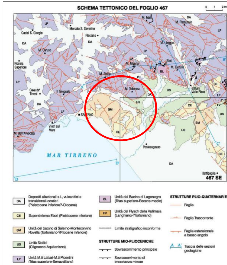
Figura 4-15. Schema tettonico del foglio Battipaglia 467 SE in cui ricadono i tratti 1-2a-2b-3 (Carta Geologica regionale 1:25000). In rosso i tratti oggetto di studio
