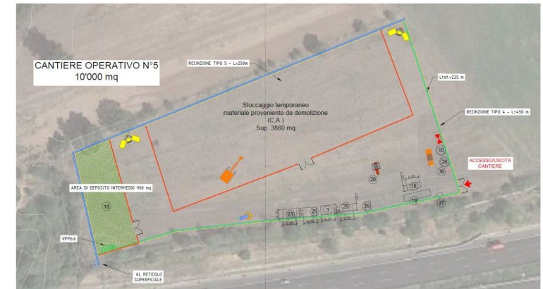
Fig. 5 - Planimetria del Cantiere Operativo n. 5
