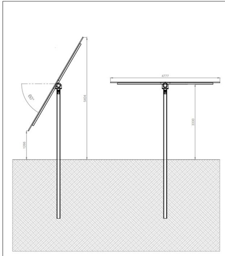
Figura 4-2: Sezione tipo struttura porta pannelli
